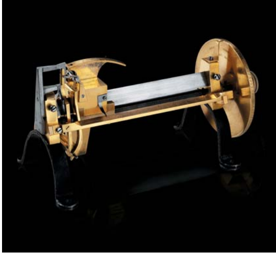
1844. Millionomètre , premier instrument capable de mesurer le micron.
