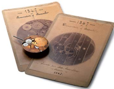
1847. Remontoir à bascule , premier système fiable de remontage et mise à l'heure de la montre sans clé.
