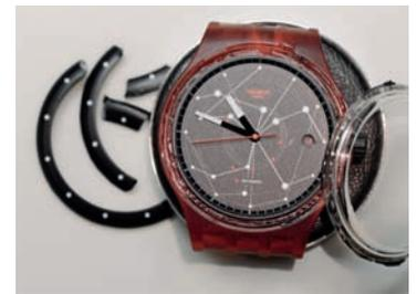
Ce cadran est dépourvu de pieds, et il est chassé dans le pourtour du boîtier. Dessous, on découvre le disque de quantité et, ce qui «bluffe» immédiatement notre horloger est effectivement l'absence de toute vis. La roue de minuterie est visible (à 9h) et détail qui démontre l'ingéniosité radicale de l'ingénierie de la pièce, elle est simplement maintenue en place par de petits ergots métalliques qui font partie intégrante de la plaque qui recouvre le centre du cadran.
