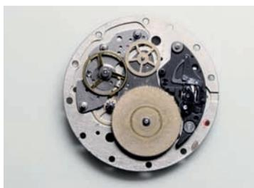
Nous nous attaquons au train de rouage. Pour y parvenir, il faut parvenir à dégager le pont de rouage de minuterie (à 3h) qui maintient le système de minuterie et la tirette permettant de positionner les différentes fonctions commandées par la couronne. Mais ce pont de minuterie, en plastique, est récalcitrant et ne veut pas se laisser démonter. C'est une des pièces les plus complexes de l'ensemble et toute une série de petits composants sont comme
