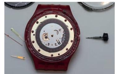
Il nous faut maintenant retourner la montre pour pouvoir dégager le mouvement. La masse oscillante est un disque de plastique qui ne remonte que dans un sens et semble assez libre. Elle tient au centre, sur un roulement à billes qui vient se clipser sur la tête de LA vis centrale. On parvient à la dégager.
